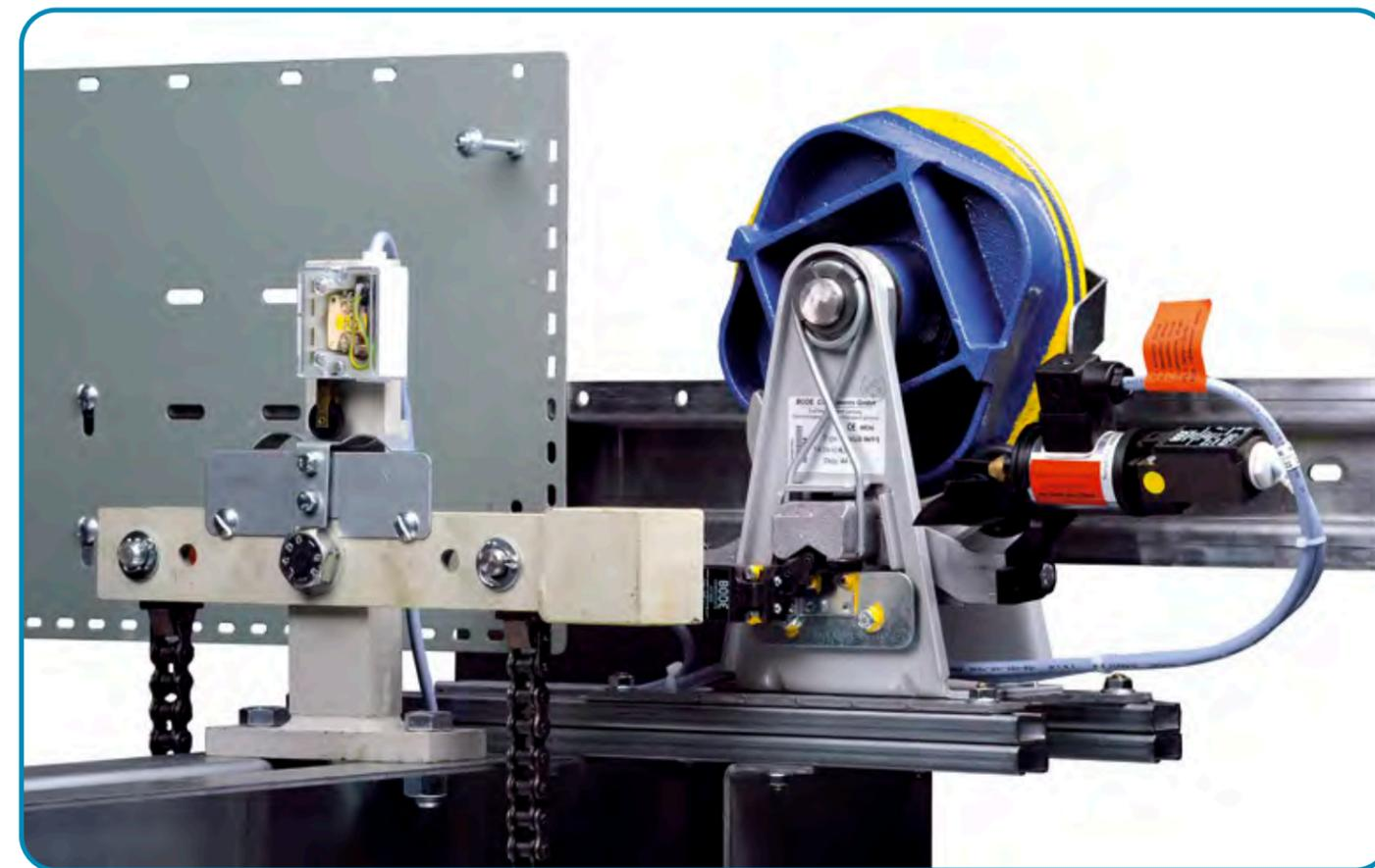
Il fermo cabina con contatto elettrico deve essere fissato sulla parte inferiore al limitatore di velocità. Il fermo cabina con contatto elettrico viene messo in funzione attraverso la fune del limitatore. Sulla fune del limitatore si trovano degli appositi nodi, i quali innestano il fermo cabina con contatto elettrico nel momento in cui la cabina deve essere regolata alle fermate.
