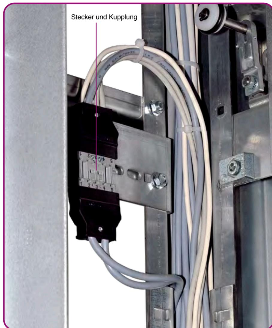
Die Kabel für Tür und Riegel sind mit Steckern und Kupplungen versehen. Beide werden auf einem Halblech befestigt. Das Halblech wird an den Eckstiel geklemmt.
