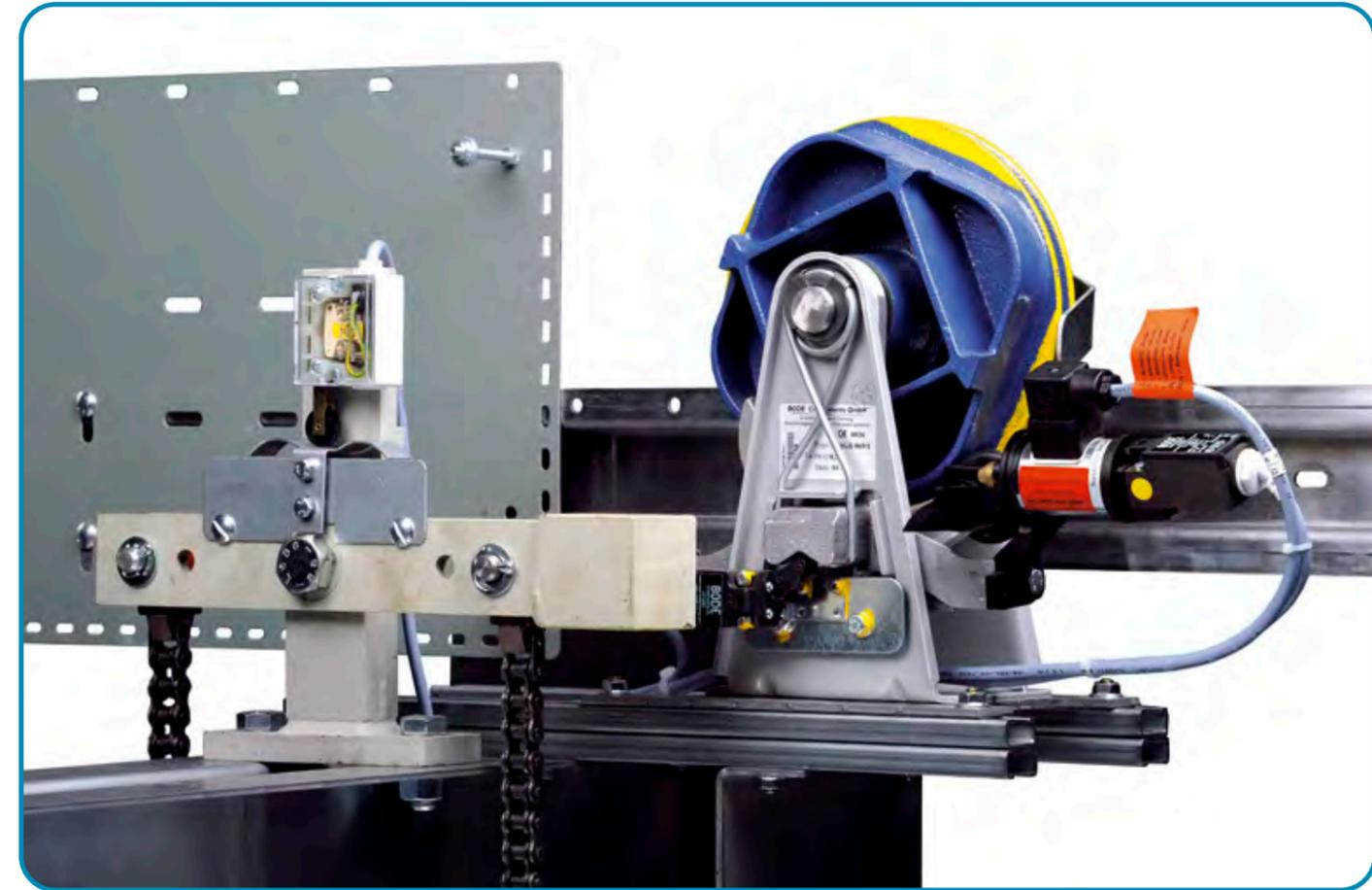
Der Hauptstrom-Notendschalter wird unterhalb des Geschwindigkeitsbegrenzers befestigt. Der Hauptstrom-Notendschalter wird durch das Begrenzerseil geschaltet. Auf dem Begrenzerseil sind Seilnüsse, welche den Hauptstrom-Notendschalter einrücken, wenn der Fahrkorb die Über- bzw. Unterfahrt oben oder unten verlassen will.
