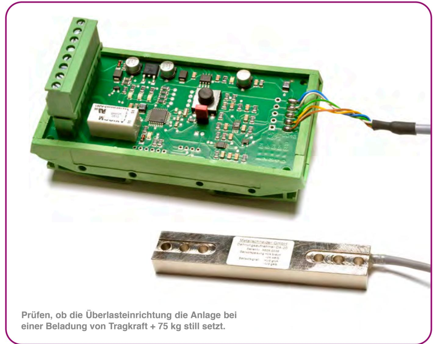
Prüfen, ob die Überlasteinrichtung die Anlage bei einer Beladung von Tragkraft + 75 kg still setzt.
