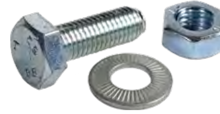
Civata M 10x30 Rondela A 10,2 Somun M 10 Tahrik ünitesi taşıyıcısı ve tahrik ünitesi için
