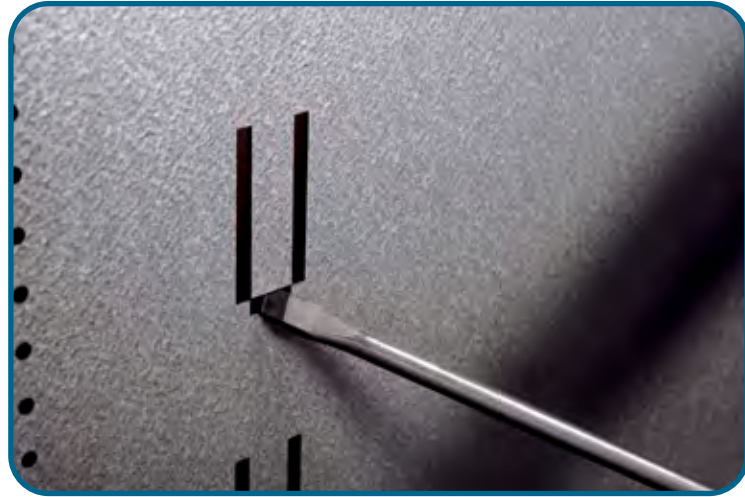
Sac kanadının bükülmesi
