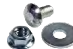
Зубчатые гайки М 8 Винты с полупотайной головкой М 8х16 Подкладные шайбы А 8,4 DIN 9021 для соединительных элементов каркаса / сдвижные накладки Диагонали / угол ножки / стеновой анкер
