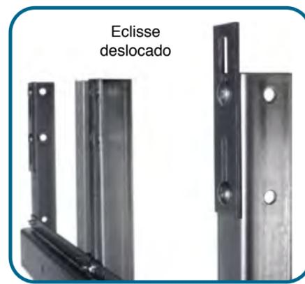
Na extremidade da guia é encaixado um eclisse de ligação na junta. Isto facilita o alinhamento das guias. Depois são aparafusados 2 eclisses de ligação nas extremidades da guia. **Só se devem apertar os parafusos depois das guias estarem alinhadas.**
