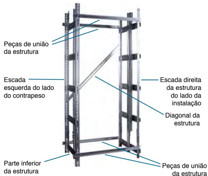
A estrutura é composta pela escada direita e esquerda da estrutura, as peças de união da estrutura e as diagonais da estrutura. As guias e a calha de instalação encontram-se pré-montadas nas escadas da estrutura.
