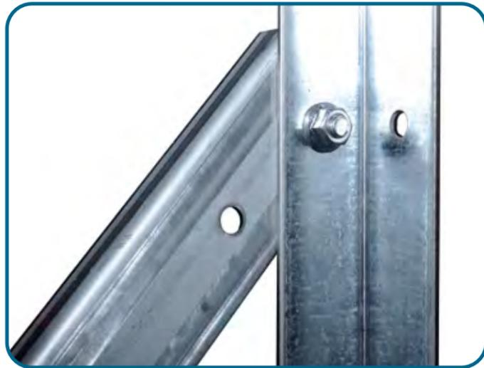
Na parte inferior da estrutura os dispositivos de segurança são montados na guia, cada um com 2 parafusos M 6. Este tipo de dispositivo de segurança só existe se a cabina não estiver equipada com amortecedores. Fixar o dispositivo de segurança estreito no lado do contrapeso (perfil em U), e o largo no lado da instalação (perfil em L).
