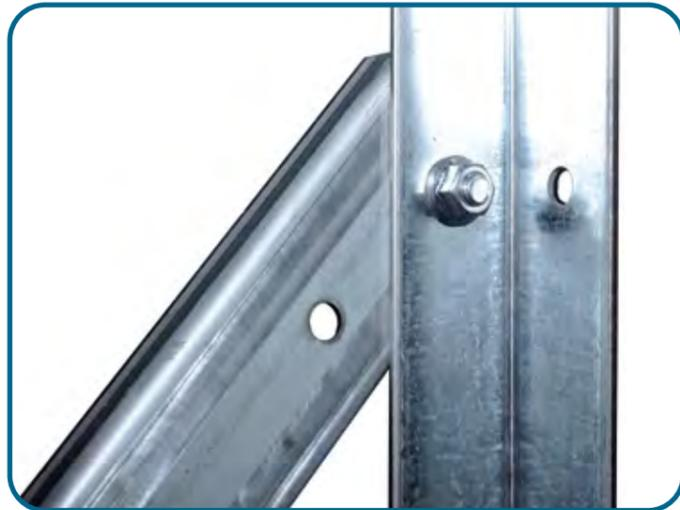
Presso la parte inferiore della struttura i dispositivi di trattenuta vengono montati sulla guida rispettivamente per mezzo di due viti M 6. Questo tipo di dispositivo di trattenuta è disponibile solo quando la cabina non è equipaggiata con respingenti. Fissare il dispositivo di trattenuta stretto sul lato contrappeso (profilo a U), e quello largo sul lato installazione (profilo a L).
