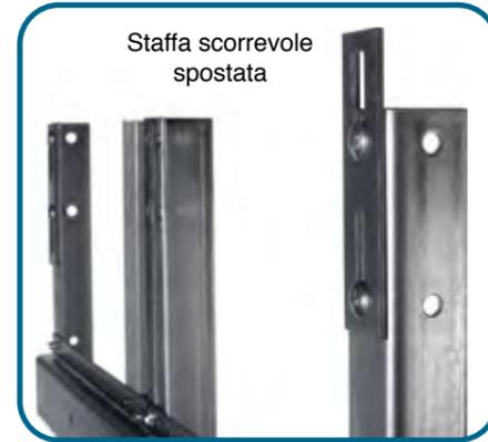
Nel giunto dell'estremità di una guida viene inserita una staffa di collegamento. Questo facilita l'allineamento delle guide. In seguito le estremità della guida vengono avvitare con 2 staffe di collegamento. **Queste viti devono essere serrate solo dopo che le guide sono state allineate.**
