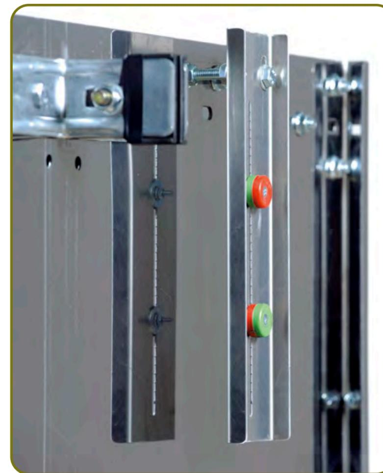
Il grembiule della cabina viene fissato al collare inferiore della cabina per mezzo delle viti con testa a calotta piatta (ciò non avviene per quanto riguarda la porta di chiusura della cabina).
