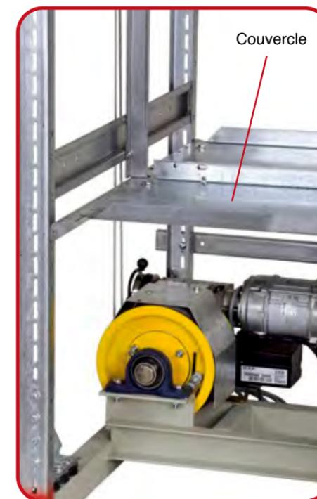
Sous le tambour se trouve une tôle de contact. Si le câble se déroule du tambour et touche cette tôle de contact, le système s'arrête tout de suite. Pour le câblage électrique voyez le schéma électrique.
