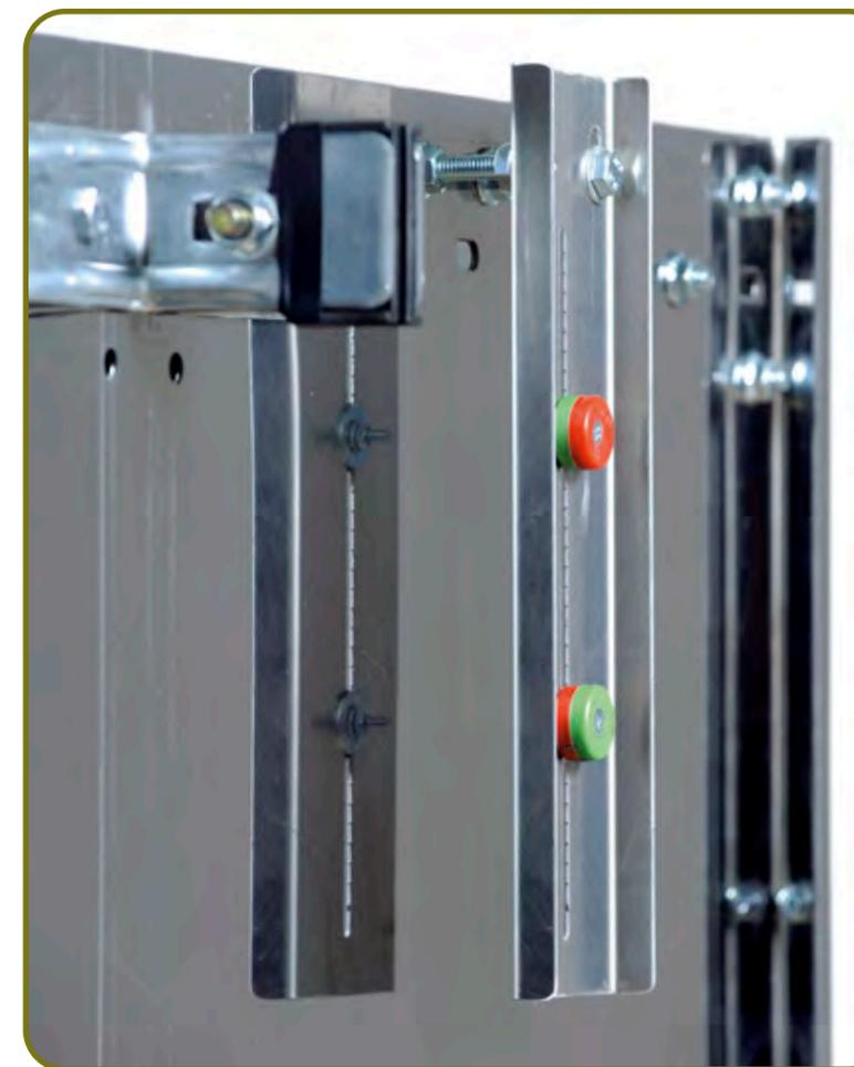
Le tablier de benne doit être fixé avec des vis plate à tête ronde au rebord de la benne (non existant avec une porte de benne).
