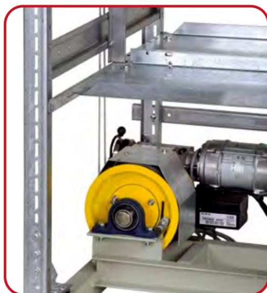
Unter der Seiltrommel befindet sich ein Kontaktblech. Sollte sich das Seil von der Trommel abwickeln und dieses Blech berühren, setzt sich die Anlage sofort still. Die Verkabelung entnehmen Sie bitte dem Schaltplan.
