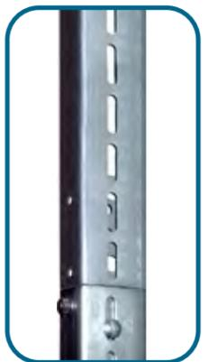
In das Ende einer Führungsschiene wird in den Stoß eine Verbindungslasche gesteckt. Dies erleichtert das Ausrichten der Führungsschienen. Dann werden die Führungsschienenenden mit 2 Verbindungslaschen verschraubt. **Diese Schrauben sollten erst angezogen werden, wenn die Führungsschienen ausgerichtet sind.**
