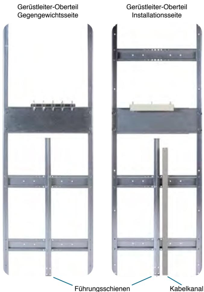
Bedenken Sie, dass der Fahrkorb in die Führungsschienen gesetzt werden muss. Wir empfehlen nach Montage der ersten Gerüstleiter den Fahrkorb mit einem geeigneten Hebezeug einzusetzen. Es ist darauf zu achten, dass die Gerüstleiter mit der Langlochreihe (U-Profil) auf der Seite des Gegengewichts (Gegengewichtsseite) montiert wird. **Im Nachfolgenden wird die Gerüstseite mit dem U-Profil Gegengewichtsseite genannt, die Gerüstseite mit dem L-Profil Installationsseite.**
