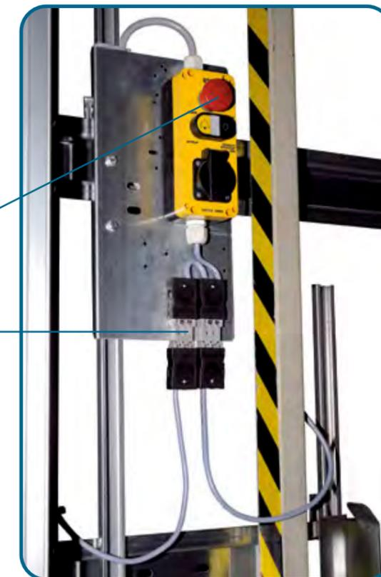
Только когда штекер ограничителя хода находится в муфте на шахтном выключателе, устройство готово к эксплуатации. По этой причине ограничитель хода подвешивается возле шахтного выключателя в каркас.
