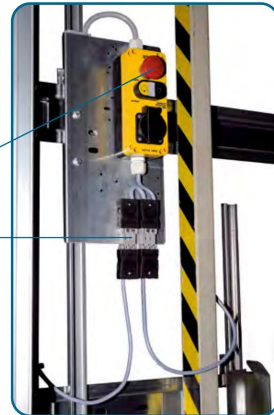
L'installation n'est opérationnelle que si la prise de la limitation hauteur se trouve dans l'embrayage près de l'interrupteur d'arrêt de la cage. C'est pourquoi la limitation hauteur doit être accrochée à côté de l'interrupteur d'arrêt de la cage dans le pylône.
