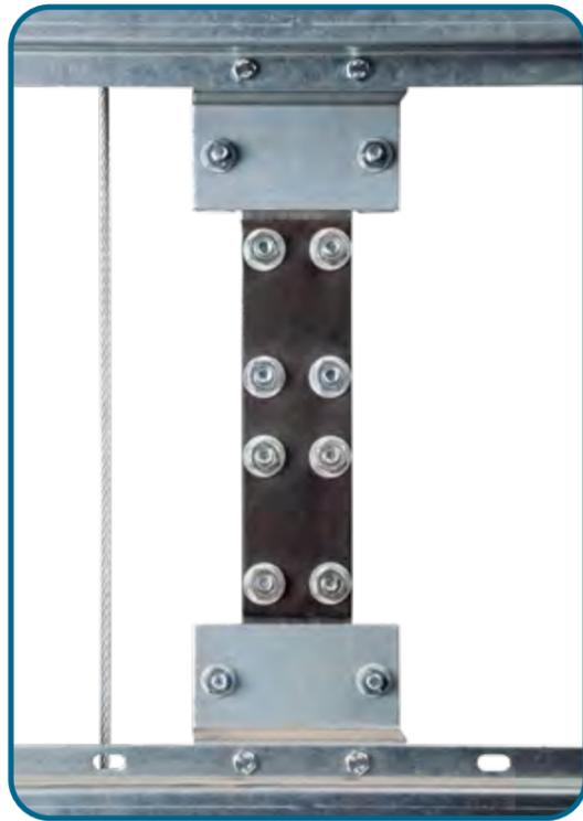
Le rail de guidage doit également être placé en dessous. Pensez que les forces du rail de guidage ne doivent pas être introduites verticalement dans le pylône. C'est pourquoi vous devez serrer et non visser les rails de guidage. Serrez les vis de serrage une fois que le rail de guidage est aligné.
