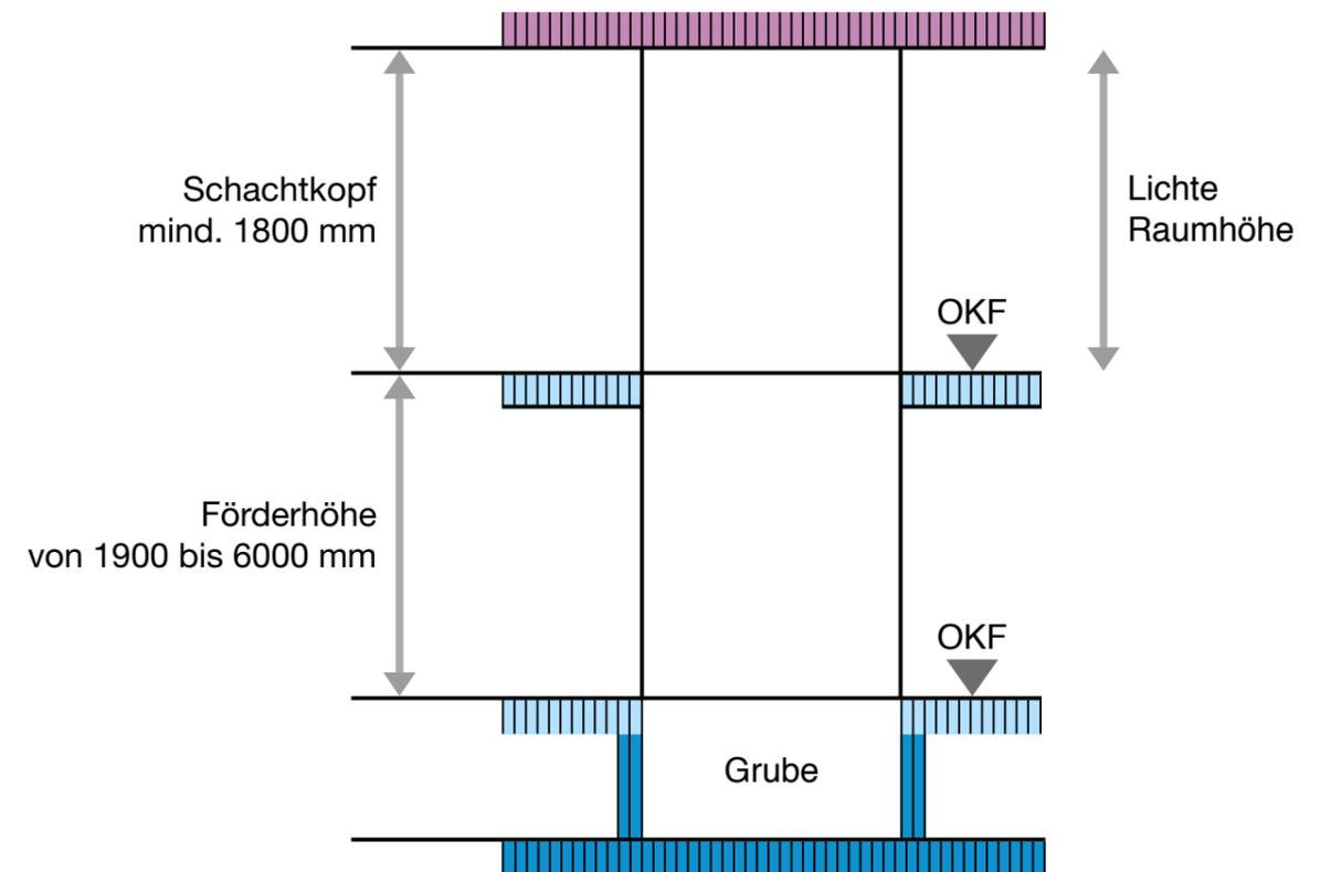
Unterfluraufzug ISO-U mit einer Tragkraft von 300 kg
